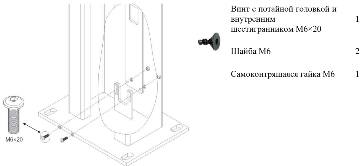
Рисунок 3.6 – Закрепление стопорных реек снизу
